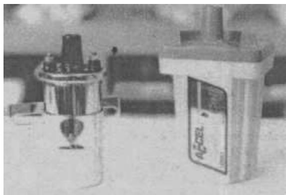
*Напряжение во вторичной обмотке управляет не только тем, как быстро спадает магнитное поле, но и тем, какова была напряженность магнитного поля перед спадом. Катушки зажигания высокой энергии (подобные показанной справа катушке ACCEL SUPER COIL) имеют меньше витков в первичной обмотке, что приводит к генерации большего тока и к более быстрому возрастанию магнитного поля.*
