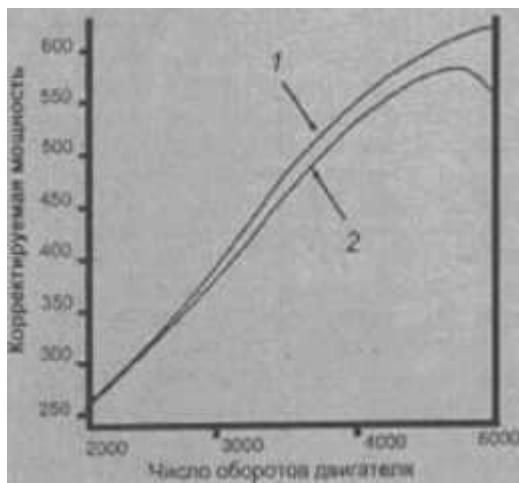
**1 - электронная система зажигания; 2 - стандартная система зажигания**
