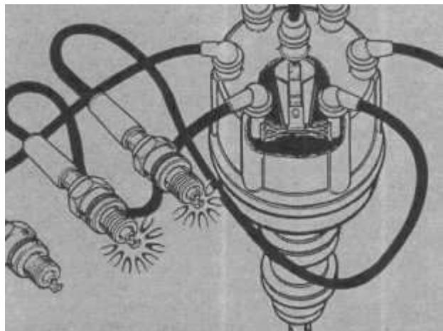
*Если ротор направлен прямо на нужный контакт в тот момент, когда генерируется импульс высокого напряжения, все работает хорошо. Однако если ротор находится посередине между двумя контактами, то энергия может пойти на ненужную в данный момент свечу, на две свечи сразу или, если зазор между ротором и ближайшим к нему контактом в крышке достаточно велик, то энергия может не поступить ни на одну свечу.*
