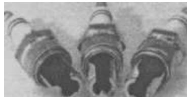
*Проверки мощности показали ее небольшое увеличение при использовании электронного зажигания с более "холодными" свечами и увеличенным зазором между их электродами. Эти свечи ACCEL изменяются от "холодных" (слева) до стандартных (справа) и "горячих" (в центре), калильное число которых определяется длиной изолятора.*
