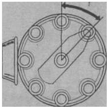
*Ротор распределителя зажигания проходит 45° за 0,002 сек, когда двигатель работает при 7000 об/мин; 1 - 45°.*
