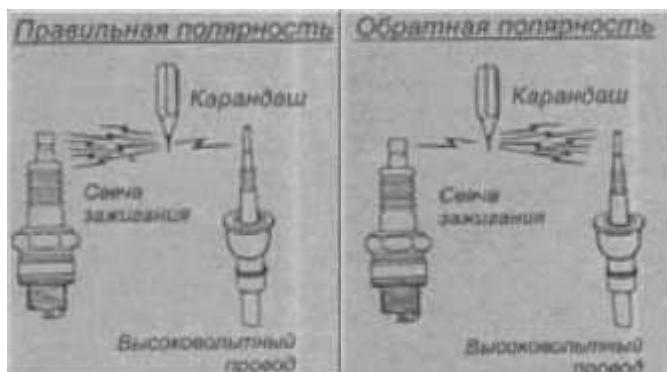
*Здесь показан легкий путь проверки полярности подключения вашей катушки зажигания. Удерживая конец высоковольтного провода рядом с заземлением, вставьте грифель карандаша в этот зазор. Если искры большие в зазоре между концом карандаша и заземлением (слева), то полярность правильная, а если их больше в другом зазоре, то полярность обратная*
