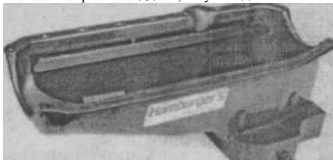
*Если вы просто устанавливаете отражатель, то для его крепления будет достаточно воспользоваться болтами. Для предотвращения ослабления отражателя и утечек масла через места крепления можно использовать пайку для болтов, гаек и резьбы. Этот поддон фирмы HAMBURGER подходит для использования в моделях "CHEVROLET" CORVET, CAMARO, и в PONTIAC FIREBIRD выпуска 1982-88 гг.*
